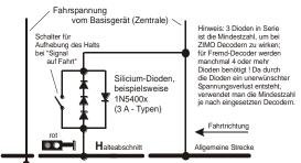
parallelgeschaltet. Der unterschiedliche Spannungsabfall erzeugt eine Asymmetrie von ca. 1 bis 2 V. Die Einbaurichtung der Dioden bestimmt die Richtung der Asymmetrie und damit die Fahrtrichtung, in welcher der Signalstopp eintreten soll.
