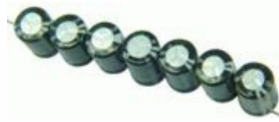
GoldCap-Module mit 7 GoldCaps (7 x 1F in Serie, also 140.000 µF / 17,5 V)
